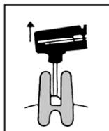
3 ポストの穴にシリンジの針を奥まで挿入し寒天を出しながら静かに抜いて寒天を注入します。
