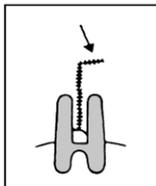
2 ワイヤーの先端を直角に曲げて下さい。その状態でポストから取り出します。
